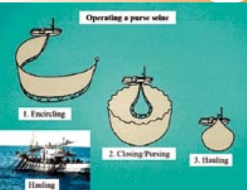
Schematic of a purse seiner (FAO)
