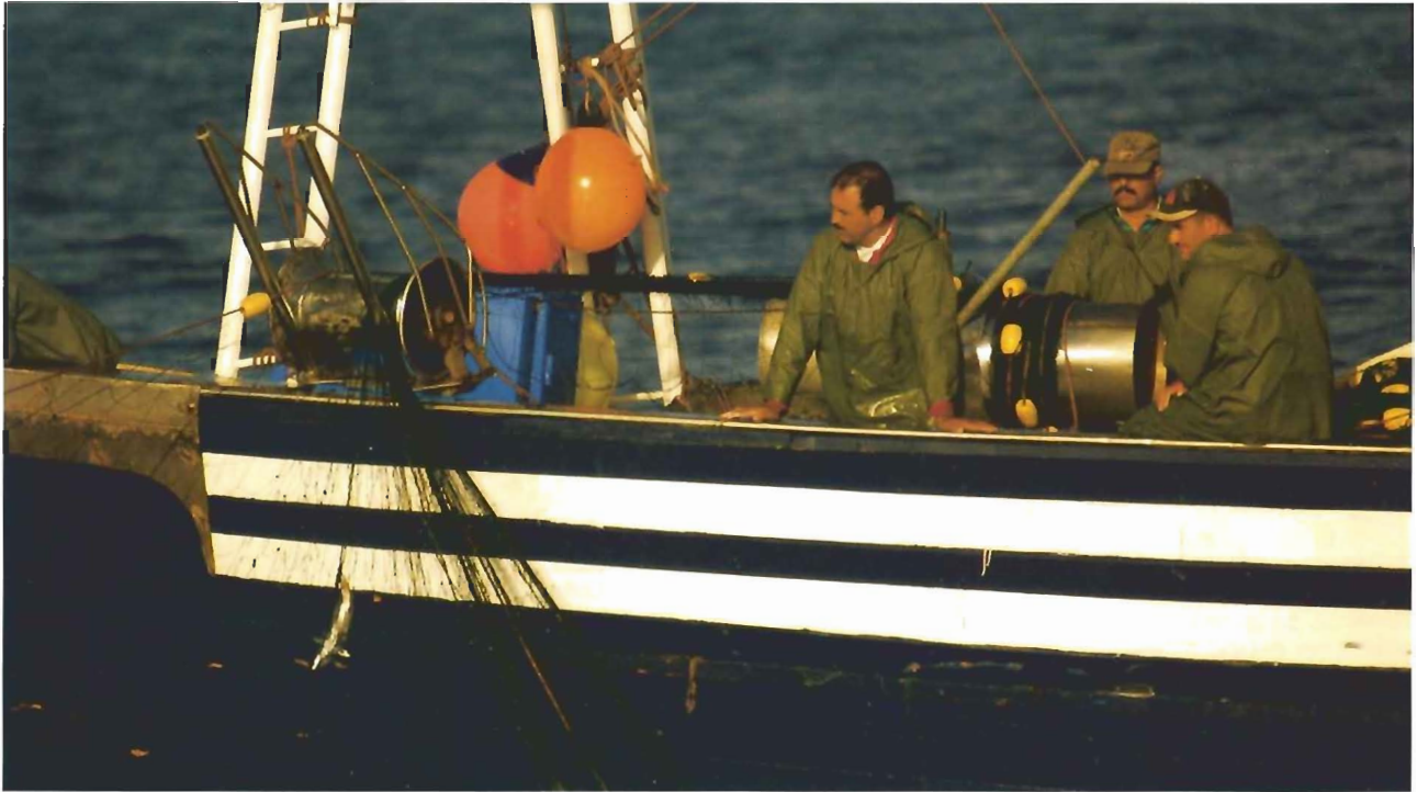
© OCEANA/Juan Cuetos. Halador y molinete a bordo de un redero de deriva marroquí. Mar de Alborán, agosto de 2006.
